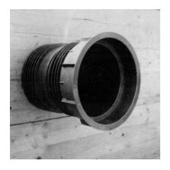
2. Die Rohrdurchführung stecken Sie auf die Schalungshilfe. <u>Hinweis:</u> Der Verlängerungsteil (Muffe) sollte immer gebäudeaußenseitig angeordnet werden (ermöglicht erhöhten Setzungsschutz).
